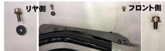
③シートを取り付けます。フロント側はM8×20キャップボルト+M8平ワッシャ
