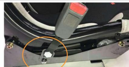
②シートベルトキャッチを取り付けます。サイドステーに補助ステーを取り付け、ベルトキャッチを固定してください。角度は少し前傾で大丈夫です。コンソール傷対策のためシートベルトキャッチの背中に添付のクッションテープを貼り付けておいてください。
