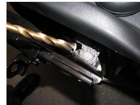
⑤ガイド穴が用意できたところで10mmでゆっくりのスピードでリベットの頭に穴を開ける ように掘り下げてください。ある程度の所でポコッと音が鳴りリベットの頭が外れます。
