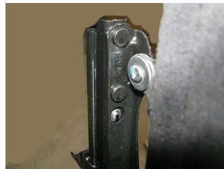
④センターポンチの打った場所にガイド穴を開けます。4mmのドリルで約5mm (リベットの頭の厚み+ワッシャ+α)の深さの穴を開けてください。 (貫通の必要はありません)
