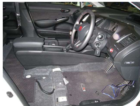
②車両からシートを取り外します。ドア側シートベルトをカバーを外し取り外します。 シートベルトの配線に注意し、ボディや内装に傷を付けないようご注意ください。 取り出し後、ハイトを最上段にしシートを横にしておいてください。
