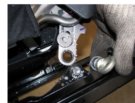
⑥マイナスドライバーでワッシャを起こすとレールが分離します。この作業を4カ所行ってください。レール分離作業終了です。
