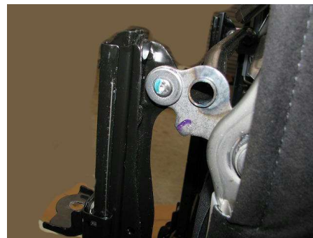
②車両からシートを取り外します。ドア側シートベルトをカバーを外し取り外します。 シートベルトの配線に注意し、ボディや内装に傷を付けないようご注意ください。 取り出し後、ハイトを最上段にしシートを横にしておいてください。
