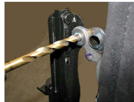
⑤ガイド穴が用意できたところで10mmでゆっくりのスピードでリベットの頭に穴を開ける ように掘り下げてください。ある程度の所でポコッと音が鳴りリベットの頭が外れます。
