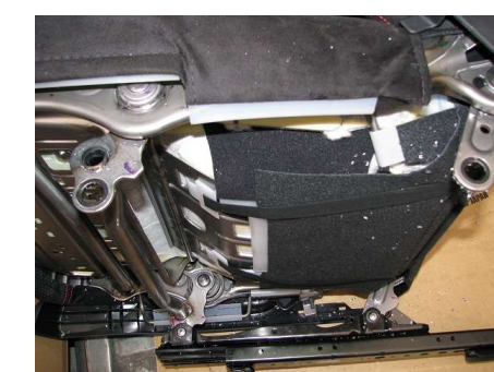
⑥マイナスドライバーでワッシャを起こすとレールが分離します。この作業を4カ所行ってください。レール分離作業終了です。
