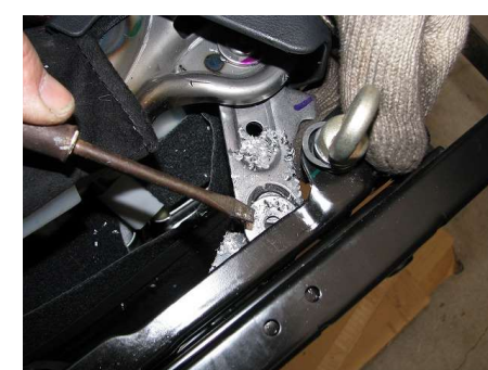
⑥マイナスドライバーでワッシャを起こすとレールが分離します。この作業を4カ所行ってください。レール分離作業終了です。
