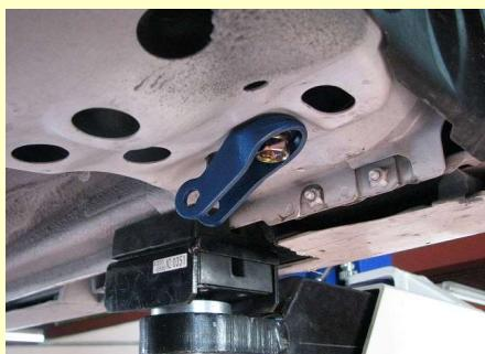
**フロント側** MA0420-OPF-08 前側ブラケットは、添付のナットプレートを写真の位置から入れブラケットを固定してください。
