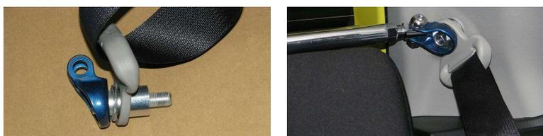
画像を参考に、シートベルトを取り外し、ブラケットを挟んで組み上げ仮固定します。次にシャフトを取り付けます。
