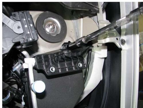
④CPU取付台のボルトを取り外します。
