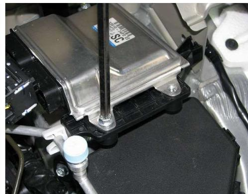
③ボルト2箇所を外し手前に上げながら引くとCPU本体が外れます。
