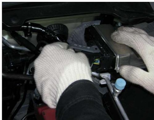
②爪を押しながらレバーを起し、CPUのカブラー2箇所を取り外します。
