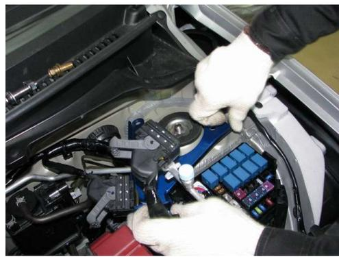
⑥ヒューズボックスの蓋を取り外してフランジを取り付けます。
