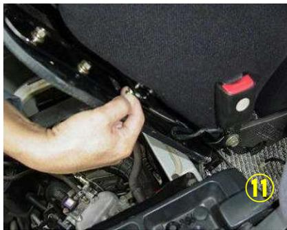
純正シートを取り外します。①②エンジンルームカバーのエンジン側に遮熱カバーが固定されていますので取り外します。エンジンルーム側の4カ所のナットを外すと純正シートとエンジンルームカバーが分離されます。③フロント側キャッチ2箇所リア側ボルト2箇所です。純正シート取り外しが出来ます。
